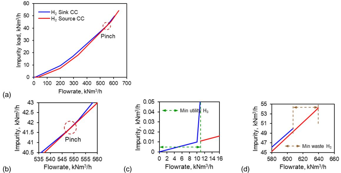
Figure 2:  $H_2$  Network Pinch diagram for (a) the  $H_2$  CC; (b)  $H_2$  Pinch; (c) minimum utility  $H_2$ ; (d) minimum waste  $H_2$  discharge
