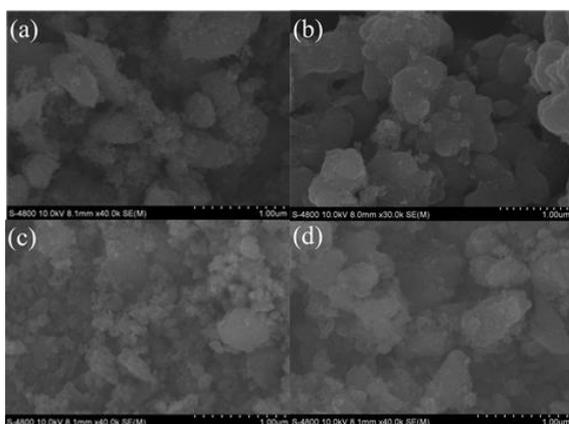
Figure 2: SEM images of (a)  $\text{TiO}_2$ ; (b) TS05; (c) TS15; (d) TS25
