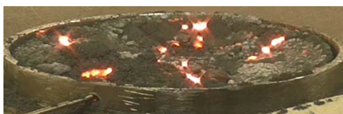
Figure 3: MIT layer test of aluminum (INERIS)
