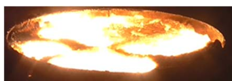
Figure 4: MIT layer test of aluminum (INERIS)
