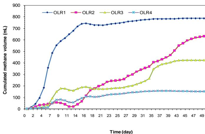
Figure 2: Cumulated  $\text{CH}_4$  volume ( $T=55\text{ }^{\circ}\text{C}$ )
