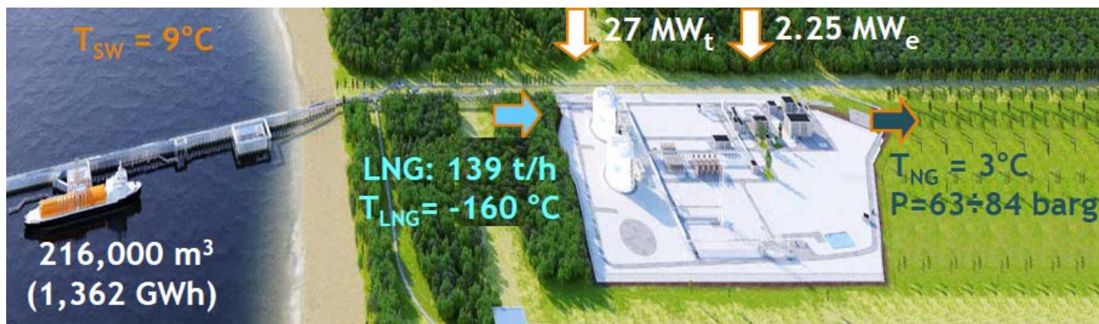
CONSUMI DI ENERGIA ELETTRICA E TERMICA PER UNA TIPICA LINEA DI RIGASSIFICAZIONE CON SCV
