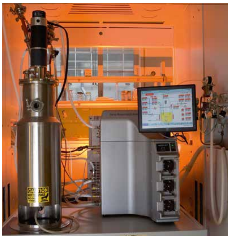
IL FERMENTATORE MESSO A PUNTO PER LA SINTESI DI OLI MICROBICI
