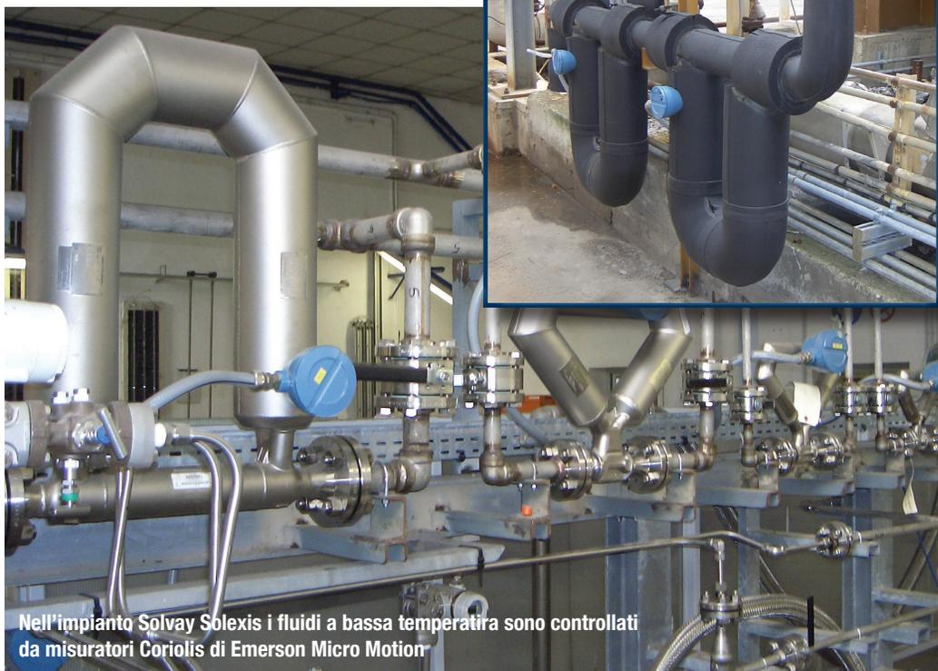
Nell'impianto Solvay Solexis i fluidi a bassa temperatura sono controllati da misuratori Coriolis di Emerson Micro Motion
